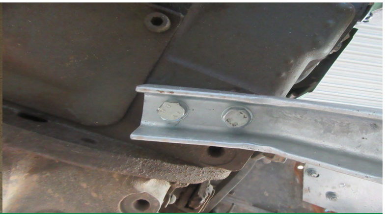
Tritthalter wird mit 2 Schrauben 12x25 mit Spreng- ring am Getriebekblock befestigt
