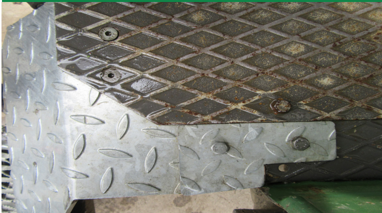
Schutzblech wird mit 2 bzw. 4 Schrauben 8x20 am Trittbrett angeschraubt
