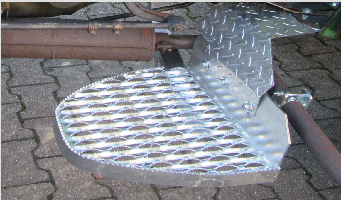
Schutzblech wird mit 2 Schrauben 8 x 30 mit dem Trittbrett verschr., 2 Bohrungen am Trittbrett anbringen
